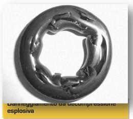
I fluidi gassosi sottoposti a enormi pressioni e a temperature molto elevate possono penetrare a fondo nelle microporosità delle gomme dando luogo a diverse problematiche, quali variazioni volumetriche e perdite dalle guarnizioni, fino anche la loro distruzione.
